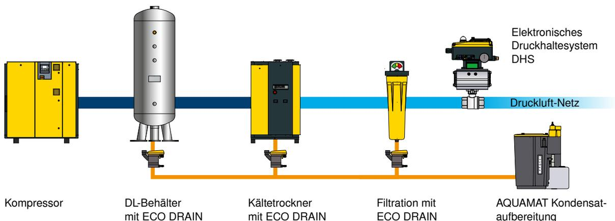
An allen Kondensat-Sammelstellen des Druckluftsystems muss eine zuverlässige Ableitung vorhanden sein. Dies geschieht am besten durch elektronisch geregelte Kondensatableiter.
